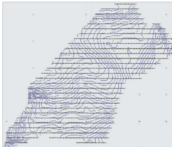
Рис. 7. Отображение ЦМР, построенной по данным SRTM, горизонталями с сечением через 1 м
