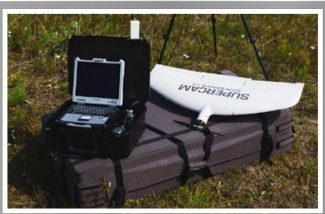
Самолетные беспилотники немного сложнее в эксплуатации, но обладают большим спектром применения в отличие от мультикоптеров
