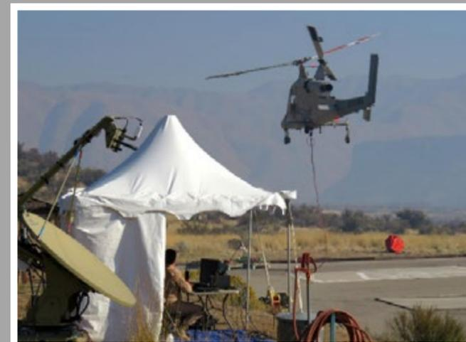
*Экспериментальная беспилотная версия вертолета K-MAX на испытаниях с водосливным устройством (ВСУ) и полевой пункт управления ею. США, 2015 г.*
