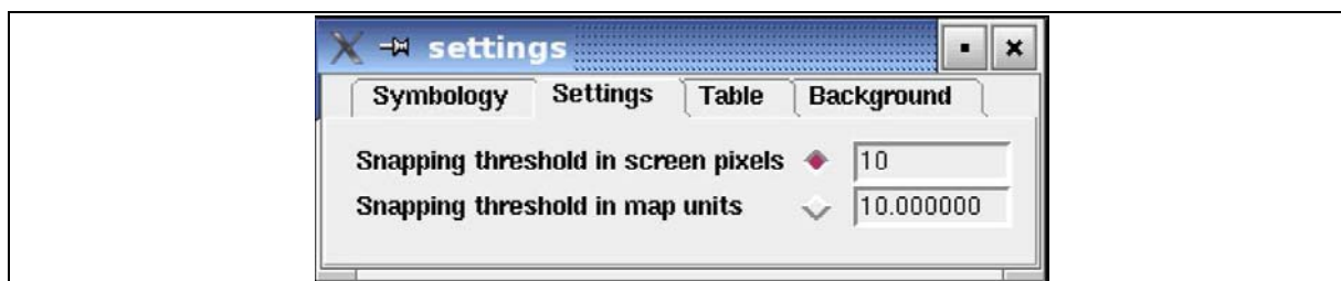
Рисунок 24: Установка порогового значения для сцепления объектов при векторизации
